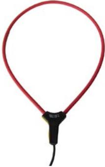
Trasformatori amperometrici apribili flessibili basati sul principio di Rogowsky per la misura di correnti da 500A fino a 4000A. Sono utilizzabili esclusivamente con gli strumenti Electrex modello Kilo F D6, Kilo F Net D6 e Giga QF Box in quanto vengono forniti con una interfaccia calibrata per questi dispositivi.
